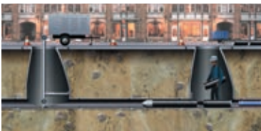
Relining brunn till brunn.
