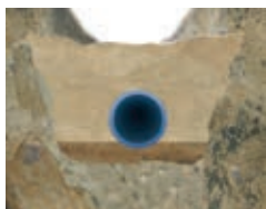
Traditionell läggning i schakt.
